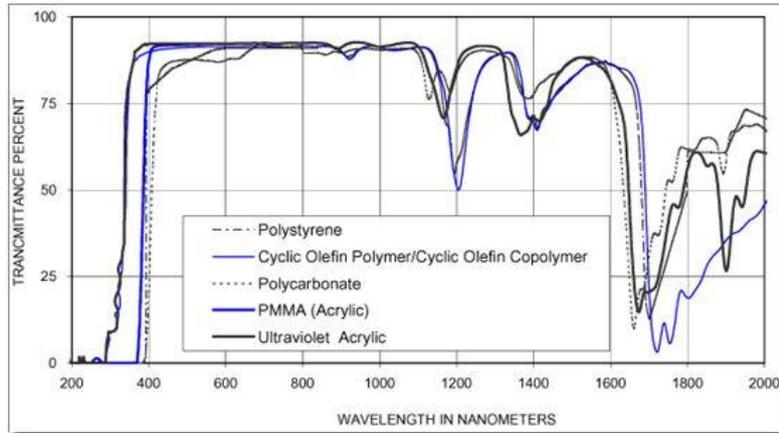
可以通过将基础聚合物与添加剂混合来改变材料的透射率，从而达到特定的光谱响应。这些添加剂可阻止材料在特定范围内的透射或改变其颜色。
