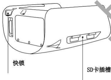
**轻松更换载荷。**通过快锁功能，可以在几秒内轻松地更换载荷。不需要任何工具，传感器高度集成化，支持操作人员的任务规划。
