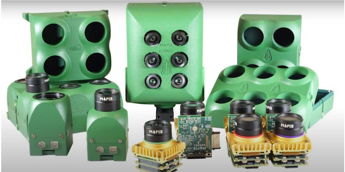
Kernel2 多通道多光谱相机是一个模块化的相机平台，可以很容易地连接在一起，形成定制的、紧凑的相机阵列。每个摄像头模块都是一个独立的 Linux 计算机，有一个传感器和存储器。模块通过连接板或断接电缆连接在一起，匹配电力和信号，允许单个端口进行阵列通信。
