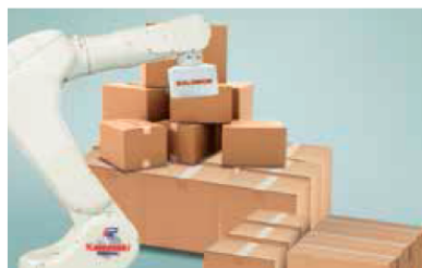
栈板多样箱型分类拆码垛
