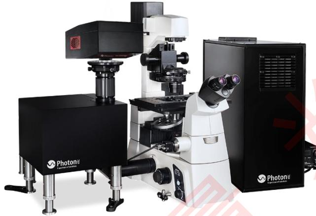
其中成像部分采用高光谱相机。不同于传统的相机采用红绿蓝三个相对较宽的光谱通道来反应光谱的范围;高光谱相机采用体布拉格光栅带通滤光片,可对较窄的光谱通道单独成像,图像中的每个像素都可获得光谱信息。
