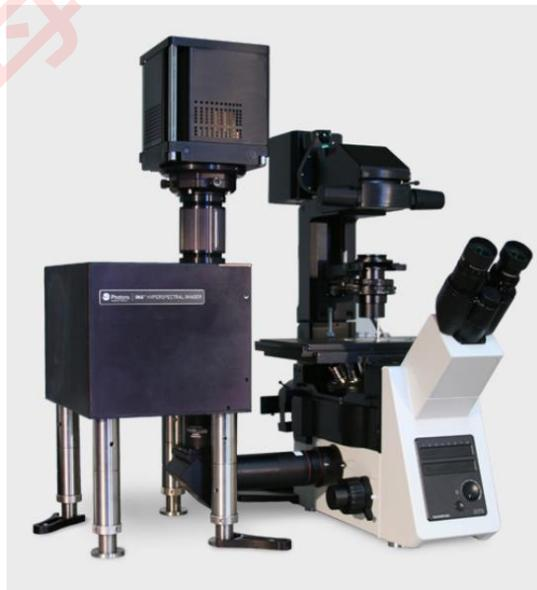
例如；单纳米管(SWNTs)具有很窄的发射峰 (20nm) 并且每个峰对应不同的 (n,m) 手性。通过红外高光谱显微镜可以在表面；活细胞内和体内用 SWNTs 空间识别分离这些物种。红外高光谱显微镜用于在活细胞或组织内的复杂环境下探究单纳米管的荧光和异质光谱。
