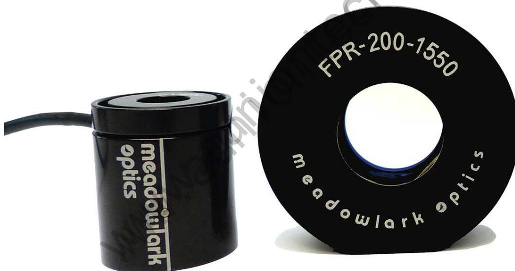
Meadowlark Optics 超快铁电液晶光学快门/光阀应采用无直流偏置的交流方波电压信号进行驱动；我们建议使用 FC-010 控制器控制超快铁电液晶偏振旋转器，FC-010 控制器是 Meadowlark 专门针对超快铁电液晶偏振旋转器进行优化的理想高性能控制器。
