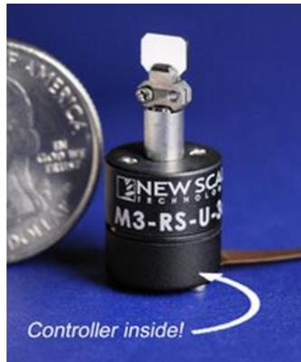
双轴光束控制系统（AU-DK-M3-RS-U-2M-20-L）
